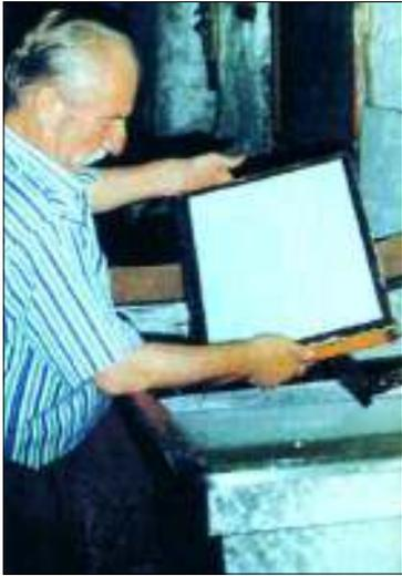
La carta a mano viene fabbricata ancora oggi con gli stessi procedimenti di un tempo e cioè immergendo la forma (telaio) nel tino contenente il miscuglio.
