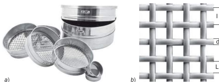
Fig. 4.2 ▶ a) Setacci con maglie di diversa luce; b) struttura della tela: d, diametro del filo; l, interasse; L, luce.
