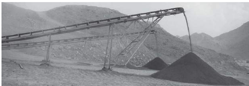
Fig. 4.12 ▶ Trasportatori a nastro depositano il materiale in cumuli di stoccaggio all'aperto.
