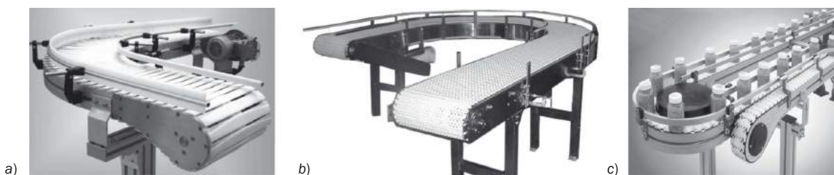
Fig. 4.18 ▶ Trasportatori a catena portante: a) con piano a listelli; b) con il piano costituito dalle maglie della catena; c) applicazione in un impianto di confezionamento.
