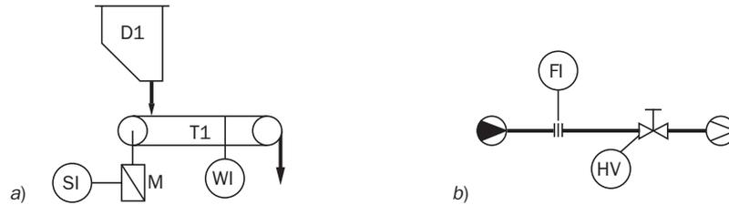
**Fig. 1.12** ▶ Esempi di processi di ordine zero con autoequilibrio. a) Ogni variazione nel numero di giri del motore M si ripercuote immediatamente sulla portata del materiale trasportato dal nastro e rilevata e indicata dalla cella di carico WI (SI: indicazione di velocità di rotazione); b) similmente, ogni variazione nell'apertura della valvola HV provoca senza ritardo apprezzabile una corrispondente variazione di portata proporzionale al guadagno statico del processo.
